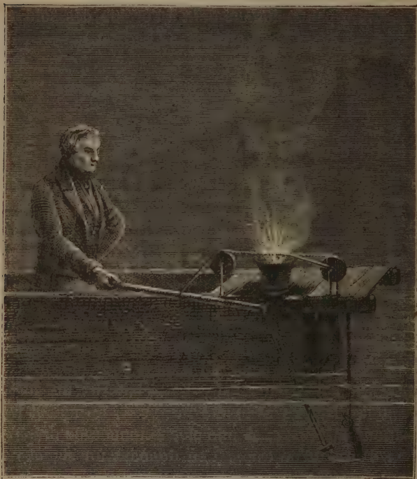
Fig. 5. — Mesure de la vitesse du son dans l'eau. Station de départ.
